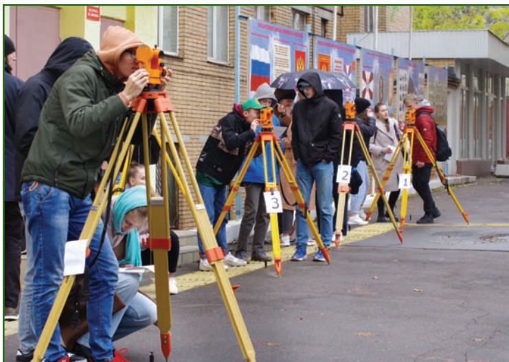
Измерение горизонтального угла полным приемом
