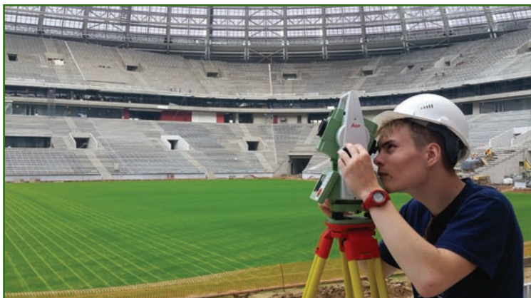
Наблюдения за деформациями крыши стадиона в Лужниках
